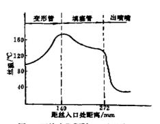
图3 丙纶在BCF加工时温度变化
